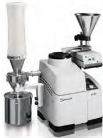
Автоматическое измельчение больших объемов пробы: ZM 200 с вибропитателем DR 100 и циклоном
