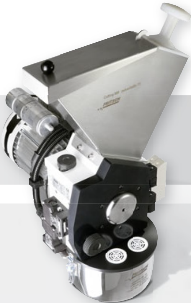
Особенно стабильная: ротор расположен на двойных подшипниках на валу и на дверце.
