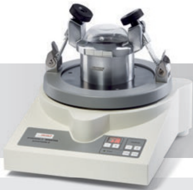
Мельница и Виброгрохот в одном приборе
